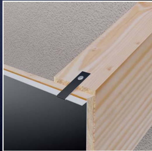
Oplechování se nahoře připevňuje příponkami ke krokvím.
