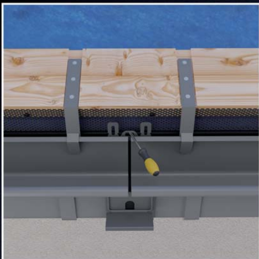
Nasazení spojky žlabu odzadu s 5-10 mm dilatací.
