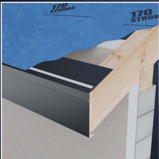
Montáž folie (DHV) a její přilepení k okapnímu plechu pod folii.
